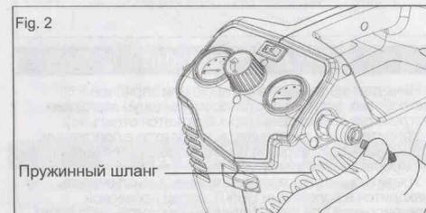
**ПРИМЕЧАНИЕ.** При подключении или отключении воздушного шланга удаляйте воздух из воздухохосборника.
