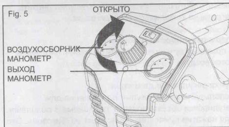
**ПРИМЕЧАНИЕ.** Воздушный компрессор автоматически запустится после того, как давление в воздухоборнике опустится ниже минимального заданного значения (давления включения).
